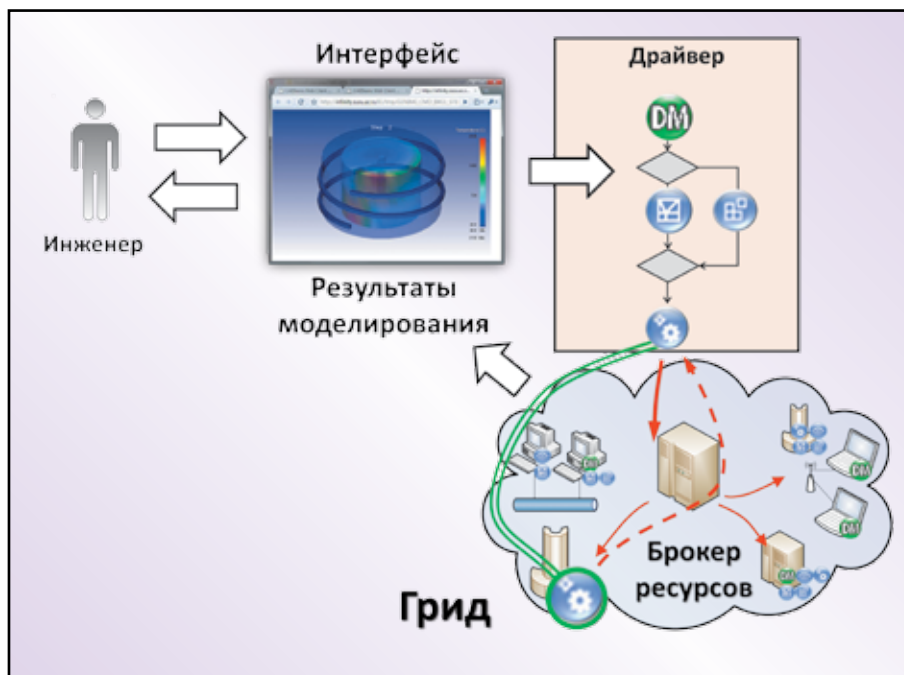
Рис. 1. Схема проведения виртуального эксперимента посредством РаВИС
